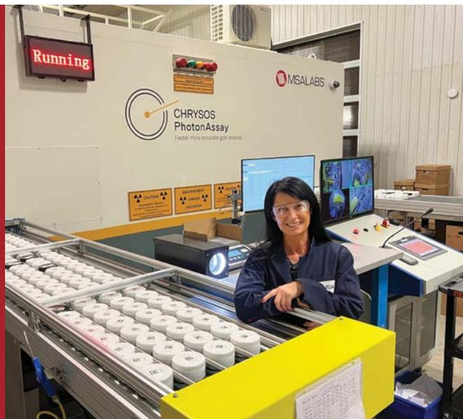
**PhotonAssay™ es una tecnología revolucionaria de ensayos con rayos X que brinda resultados de análisis más exactos en cuestión de horas, no de días o de semanas. Se trata de una alternativa al ensayo por fuego amigable con el medio ambiente y que se puede realizar en sitio o en el laboratorio.**
